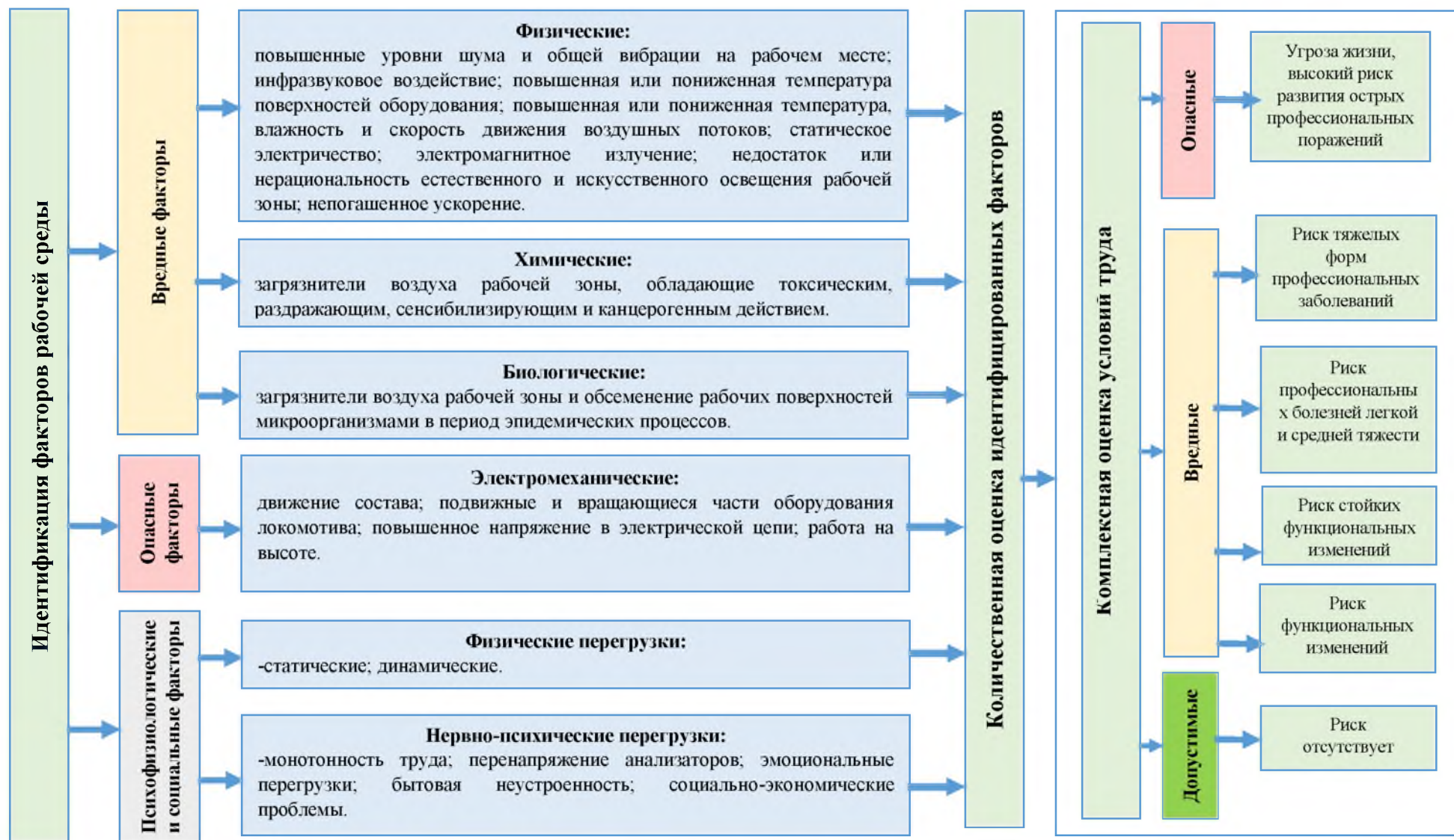
Рисунок 3.14 – Элемент схемы информационно-коммуникационной технологии гигиенической оценки труда работников, управляющих транспортными средствами
